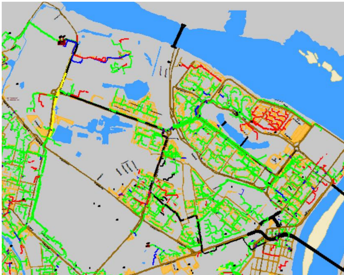
Рисунок 1.3 Результат гидравлического расчета - расчетный путь теплоносителя от СТЭЦ до ПТ-пл.Револ,7 вест2
