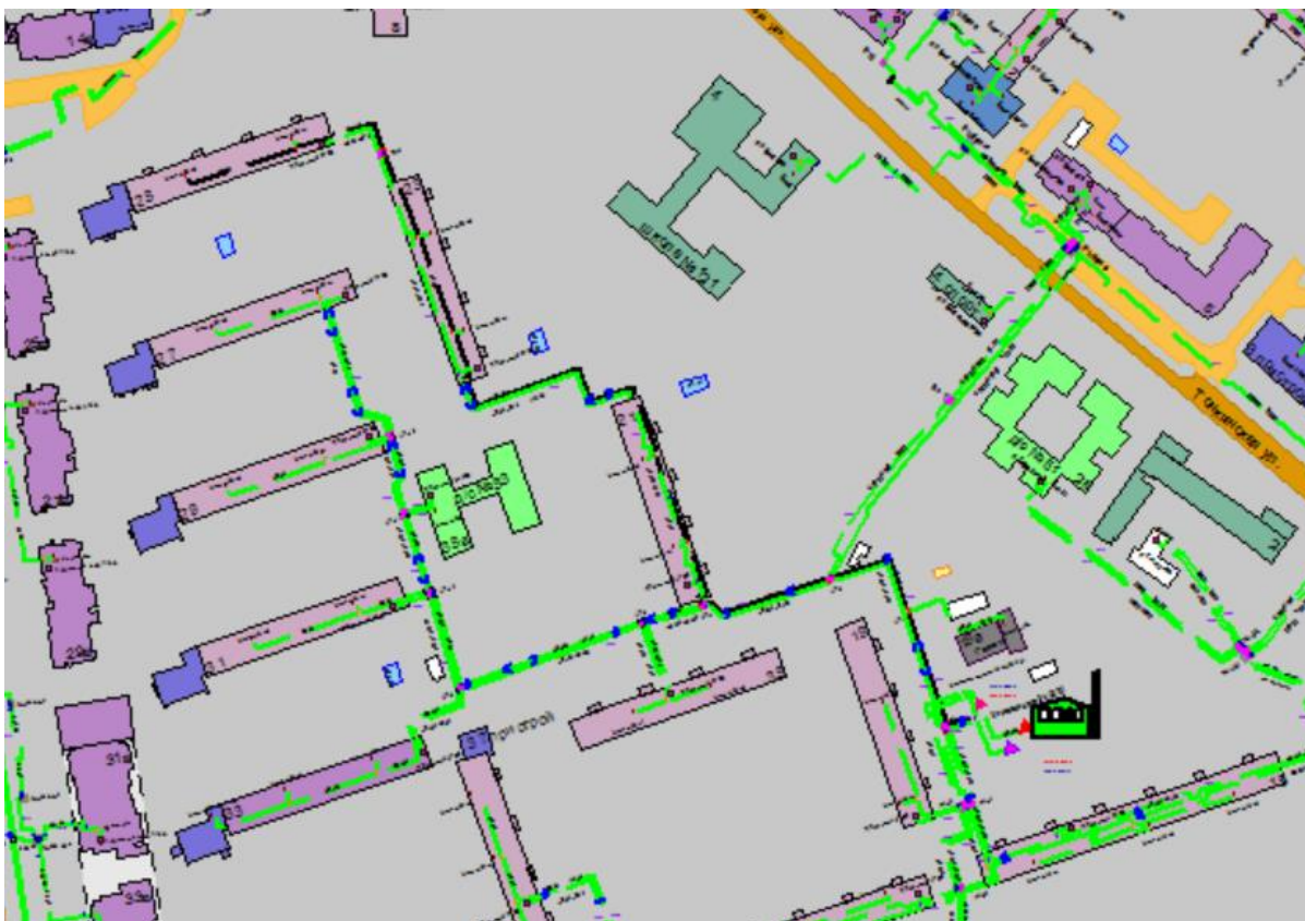
Рисунок 1.29 Результат гидравлического расчета - расчетный путь теплоносителя от котельной Московское шоссе, 15а до ПТ-Моск.ш,25 э2
