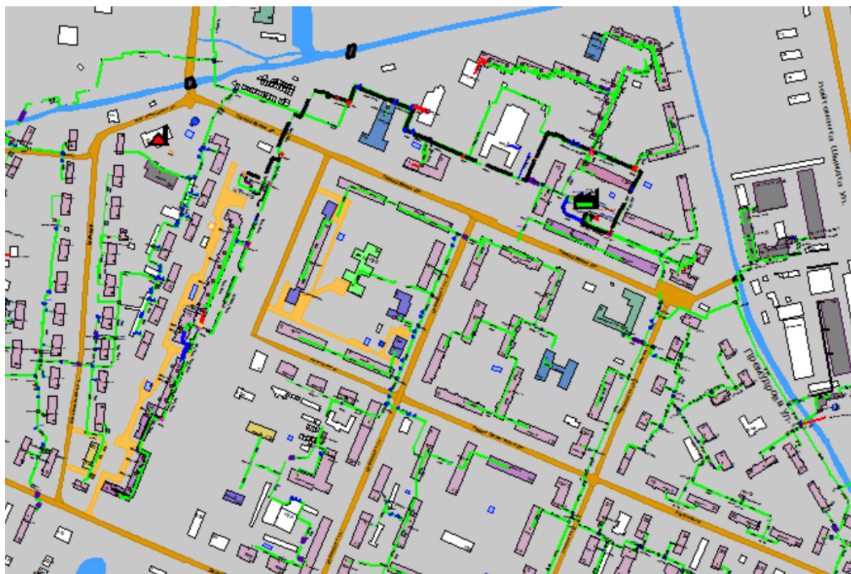
Рисунок 1.109 Результат гидравлического расчета - расчетный путь теплоносителя от котельной Премудрова, 12а до ПТ-Днепр,16 э4
