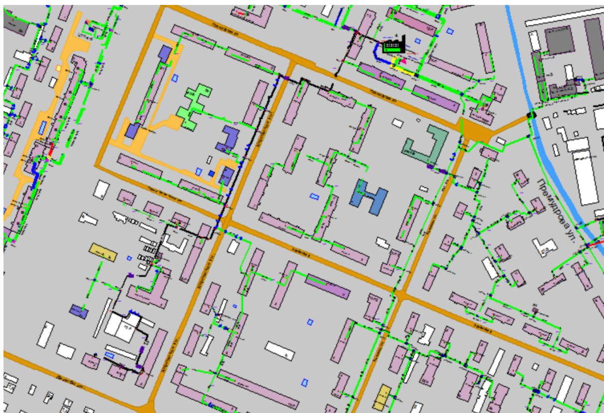
Рисунок 1.113 Результат гидравлического расчета - расчетный путь теплоносителя от котельной Премудрова, 12а до ПТ-Дружбы, 11
