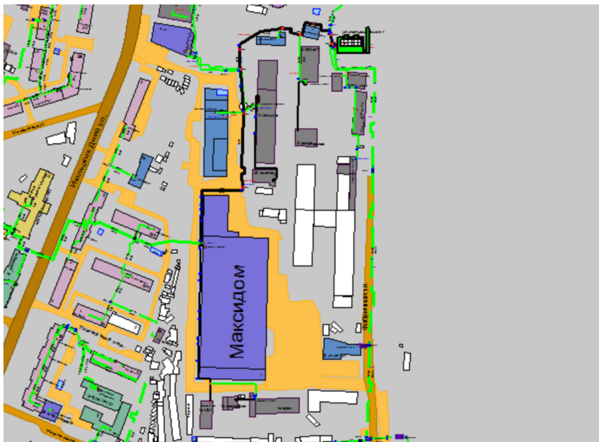
Рисунок 1.25 Результат гидравлического расчета - расчетный путь теплоносителя от Июльских дней, 1 до ПТ-Деревооб,1а АБК
