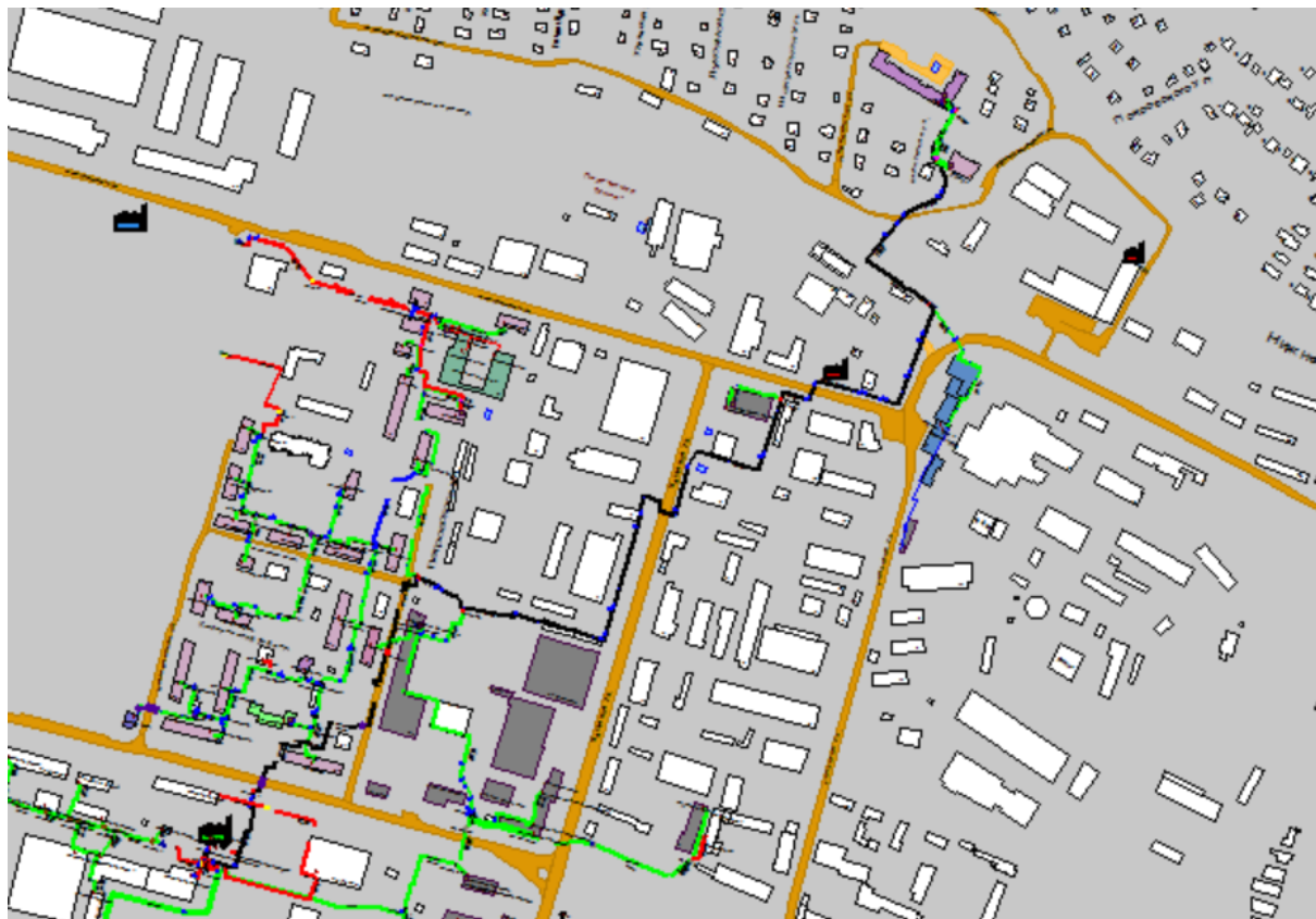
Рисунок 1.59 Результат гидравлического расчета - расчетный путь теплоносителя от котельной пр. Гагарина, 1786 до ЦТП-706
