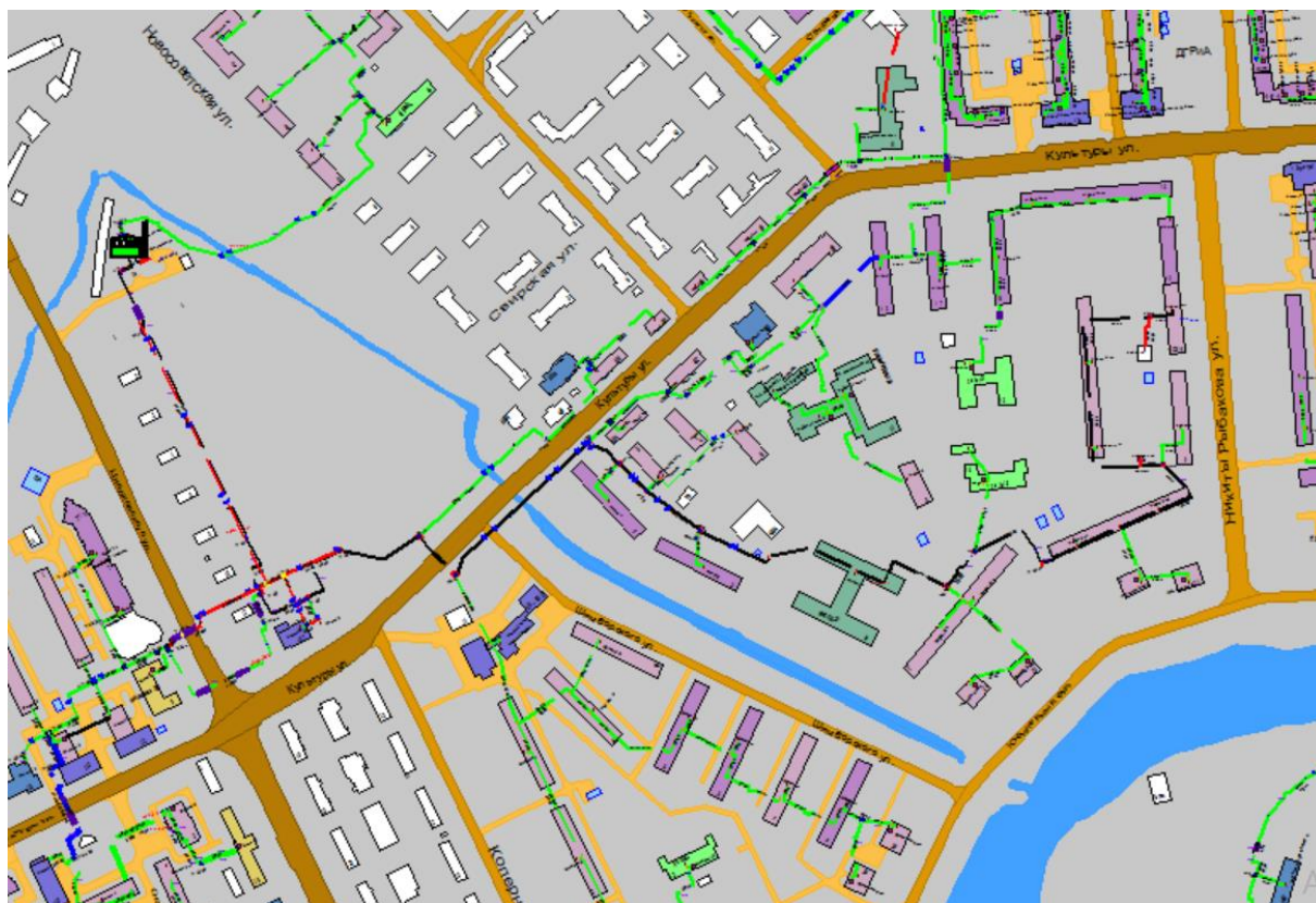
Рисунок 1.121 Результат гидравлического расчета - расчетный путь теплоносителя от котельной Коперника, 1-а до ПТ-Рыбак, 10/1
