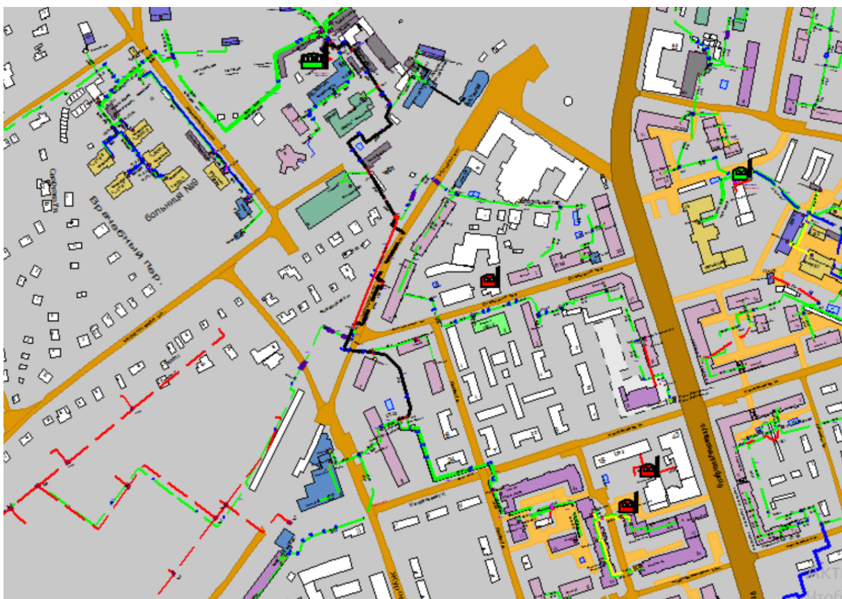
Рисунок 1.37 Результат гидравлического расчета - расчетный путь теплоносителя от котельной Климовская, 86а до ПТ-Искры, 11а
