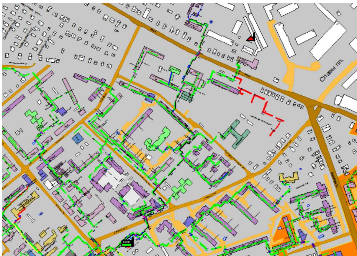
Рисунок 1.63 Результат гидравлического расчета - расчетный путь теплоносителя от котельной пр. Союзный, 43 до ПТ-Радищ,18
