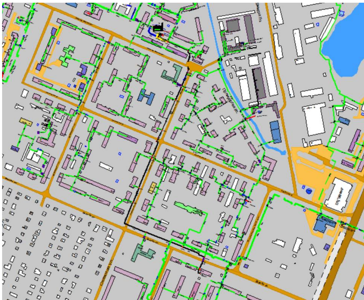
Рисунок 1.107 Результат гидравлического расчета - расчетный путь теплоносителя от котельной Премудрова, 12а до ПТ-Дружбы,56
