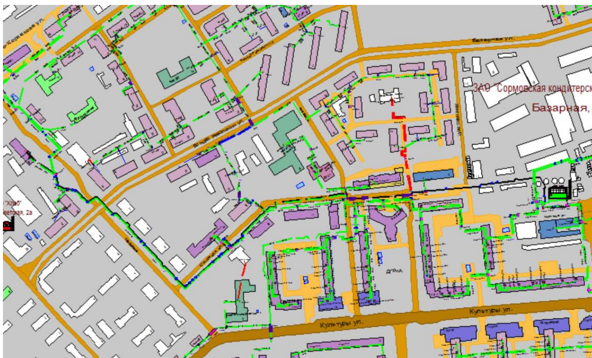
Рисунок 1.103 Результат гидравлического расчета - расчетный путь теплоносителя от котельной Пугачева, 1 до ПТ-Судостр.28
