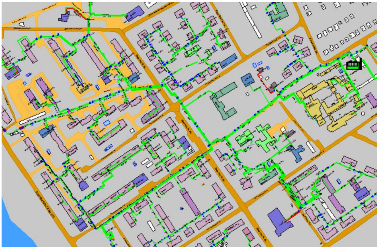
Рисунок 1.101 Результат гидравлического расчета - расчетный путь теплоносителя от котельной Таллинская, 15в до ПТ-Архан,24 вв2
