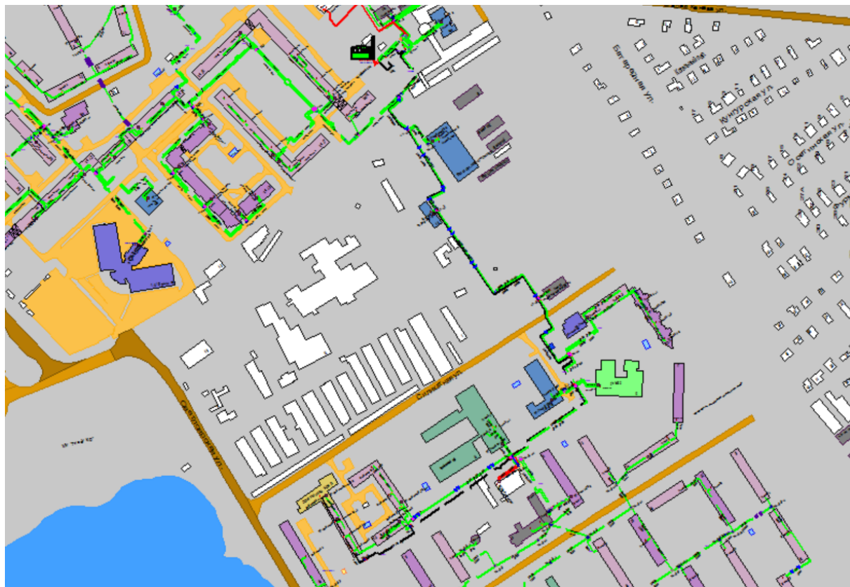
Рисунок 1.77 Результат гидравлического расчета - расчетный путь теплоносителя от котельной ул. Иванова, 14д до ПТ-Светлояр.38_полик
