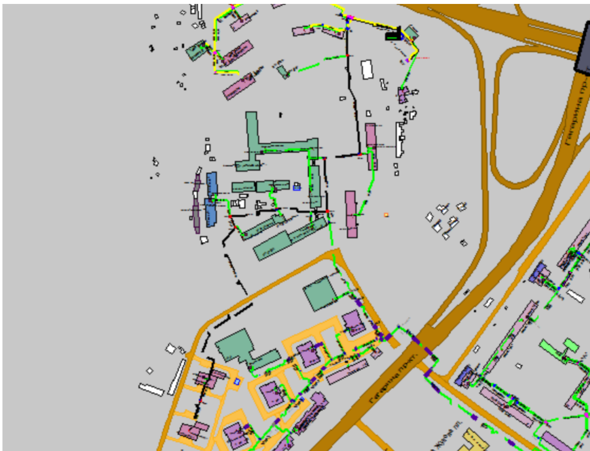
Рисунок 1.31 Результат гидравлического расчета - расчетный путь теплоносителя от котельной пр. Гагарина, 97 до ПТ-Гагар,97 общ.№1
