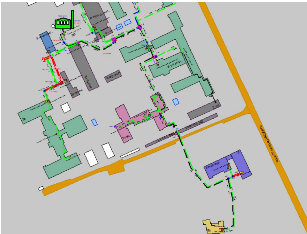
Рисунок 1.91 Результат гидравлического расчета - расчетный путь теплоносителя от котельной Анкудиновское шоссе, 3-б до ПТ-Анкуд.ш,5а
