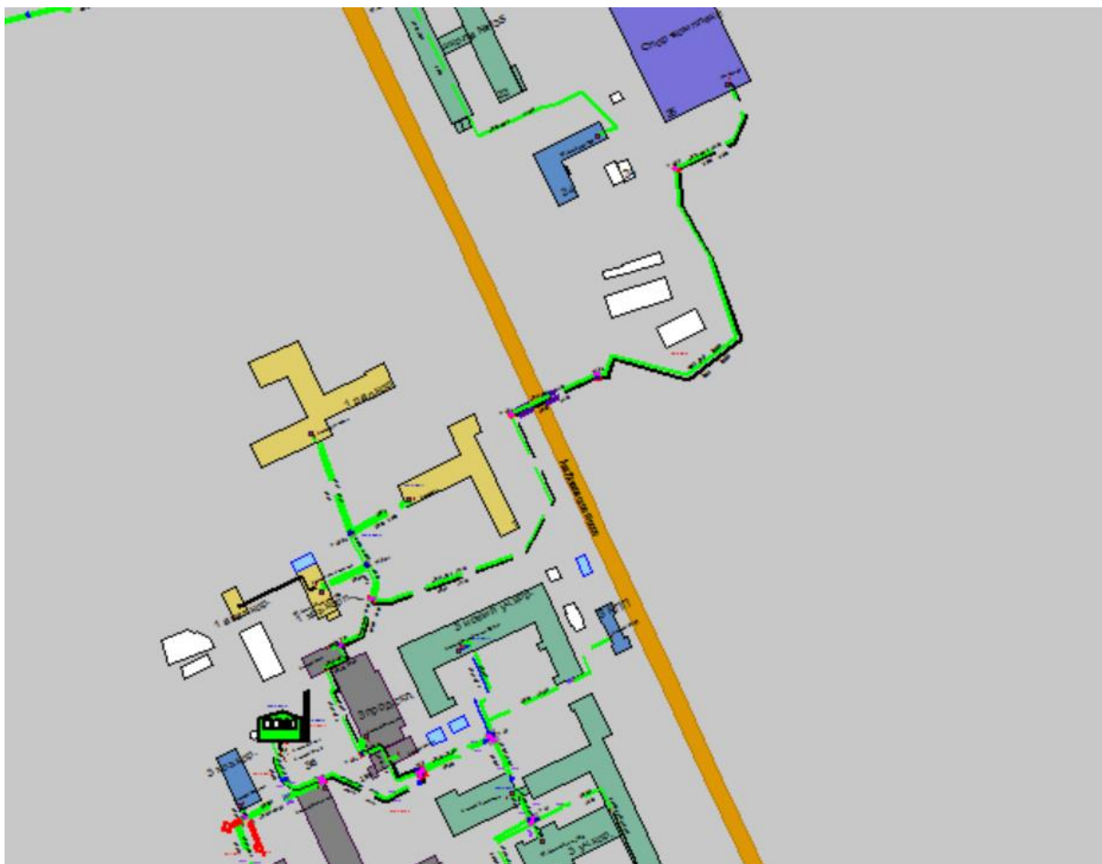
Рисунок 1.89 Результат гидравлического расчета - расчетный путь теплоносителя от котельной Анкудиновское шоссе, 3-б до ПТ-Корейск,26
