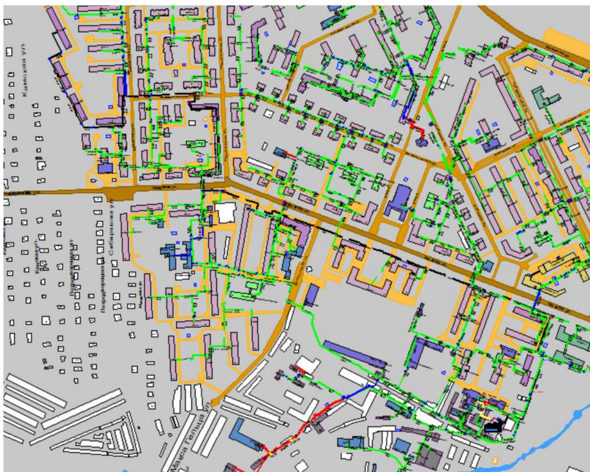
Рисунок 1.93 Результат гидравлического расчета - расчетный путь теплоносителя от котельной Чаадаева, 10 до ПТ-Мечн,63.
